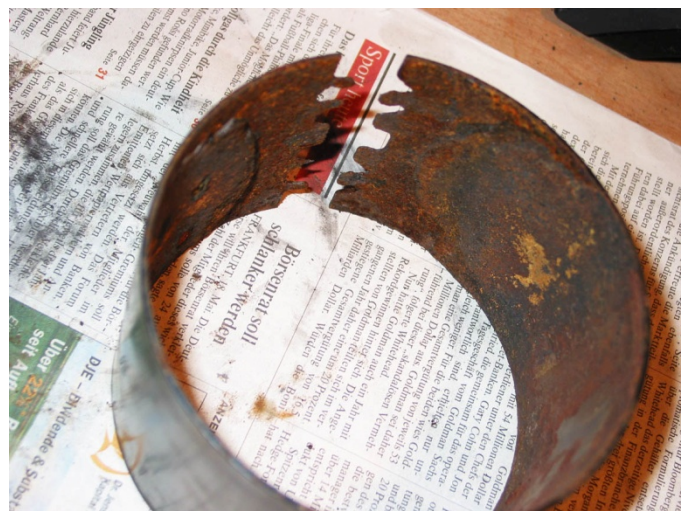
Bild 9: durchgerostetes Metallband um den Motorkörper, aufgequollenes, verrostetes Material wurde bereits entfernt.
