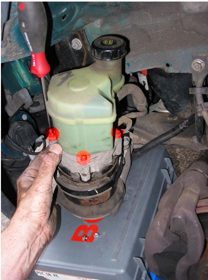
Bild 6: Trennen des E-Motors von der Pumpe: Vier 30er Torx sind abzuschrauben. Die M6 Muttern liegen bereit.
