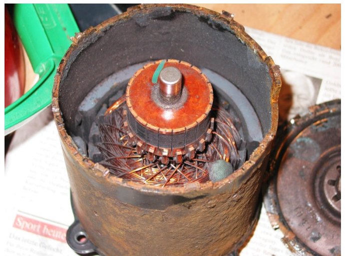
Bild 13: Blick auf den Kollektor und den Läufer. Die 4 hellgrauen Metallteile sind die Magnete.
