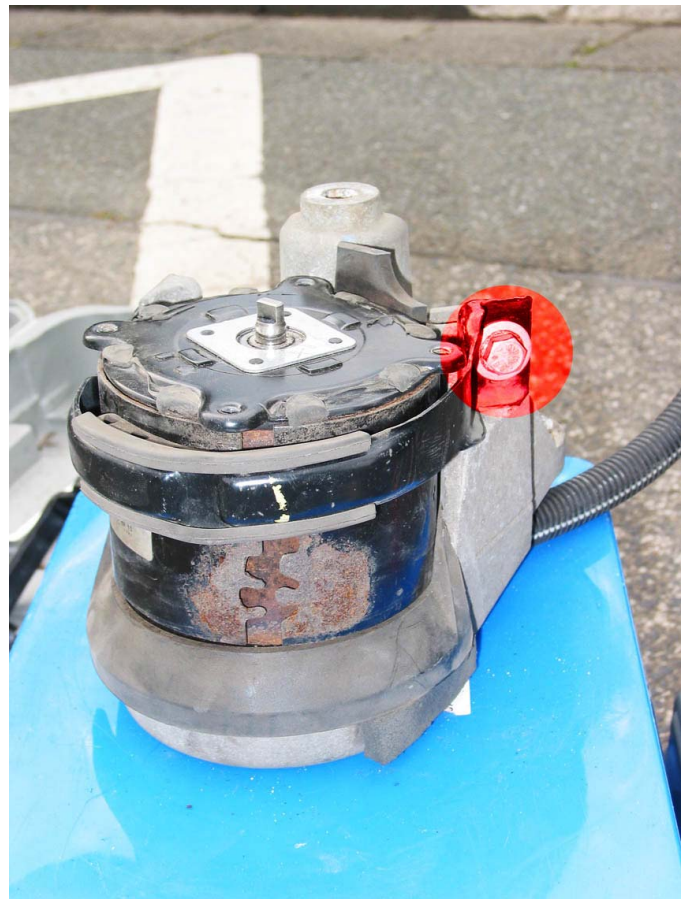
Bild 7: E-Motor in Alu-Halterung mit Metallspannband durch 13er Schraube befestigt.
