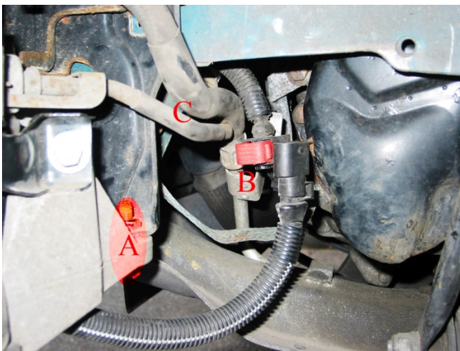
Bild 3: A: 13er Befestigung der Pumpe, B: Stecker ausgeklipst, C: Druck-Leitungen
