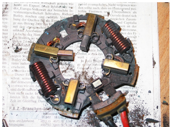
Bild 15: Der Bürstenträger und die Ursache: Die beiden Kohlebürsten am Kabel sitzen fest! Auch an der oberen Bürste erkennt man an der Flanke leichte Ansätze von Modder.
