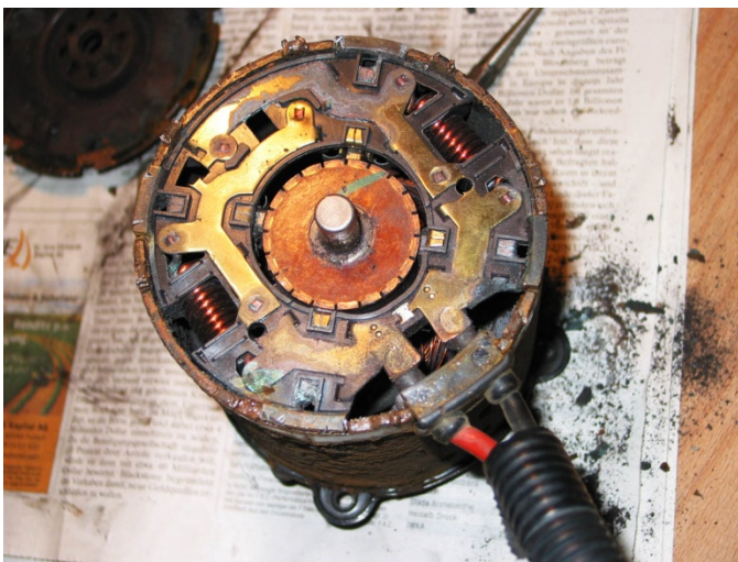
Bild 12: Deckel entfernt, Blick auf den Bürstenträger. In der Mitte des Deckels erkennt man das bewegliche Widerlager der Läuferachse.
