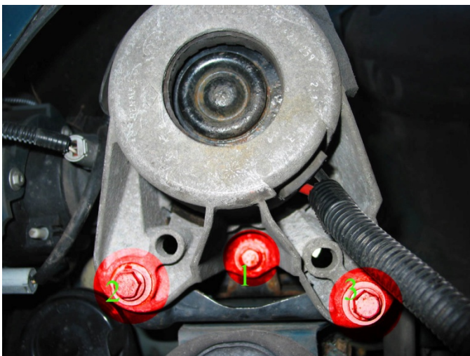
Bild 4: Befestigungspunkte der Pumpe
