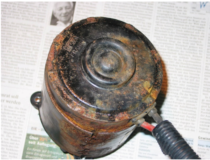
Bild 10: Deckel des Motors, mit 8 Krampen befestigt. Man sieht noch das dick aufgequollene, durchgerostete Spannband um den Motorkörper herum.
