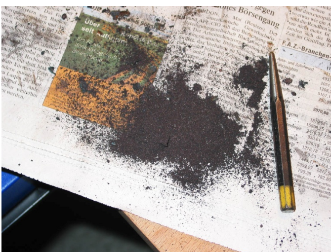
Bild 14: Metallstaub und Schmutz aus dem Motor. Der Körner dient zum Zurechtengeln der Krampen.
