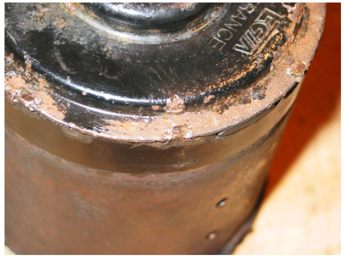
Bild 11: 3 Metallkrampen in Großaufnahme, nach Zusammenbau breitgeklopft.
