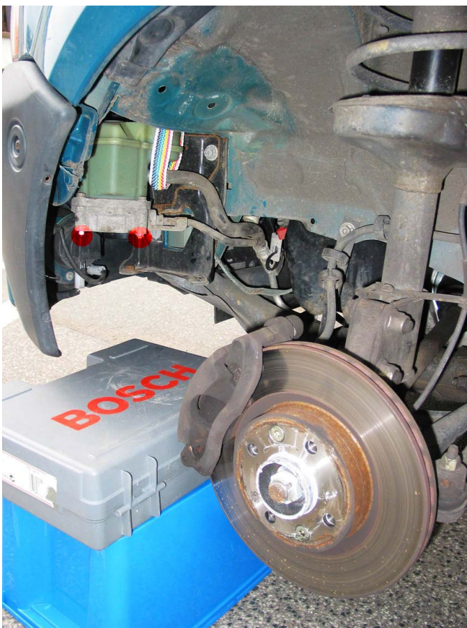
Bild 8: Pumpe mit 2 Muttern M6 gesichert (rote Kreise) und in der ursprünglichen Lage mit einem Spannband gesichert.
