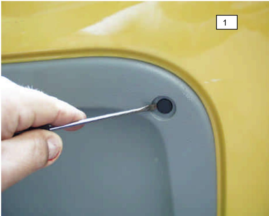
Die Verkleidung hängt danach am oberen Teil noch mit drei Knöpfen an der Tür fest. Unter vorsichtigem Ziehen löst man die Verkleidung vollständig.
